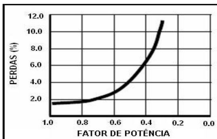
Figura 2: Perda de energia nos condutores devido ao baixo FP.
