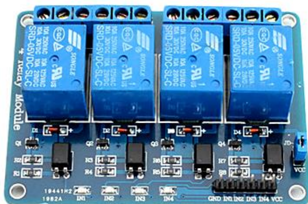
Figura 7: Bloco com relés, responsáveis pelo chaveamento do banco de capacitores no sistema.
